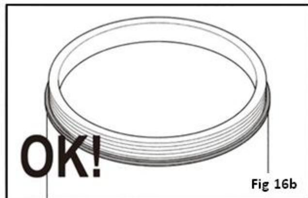
Inumidire la guarnizione con acqua e rimontare in posizione la vasca.
