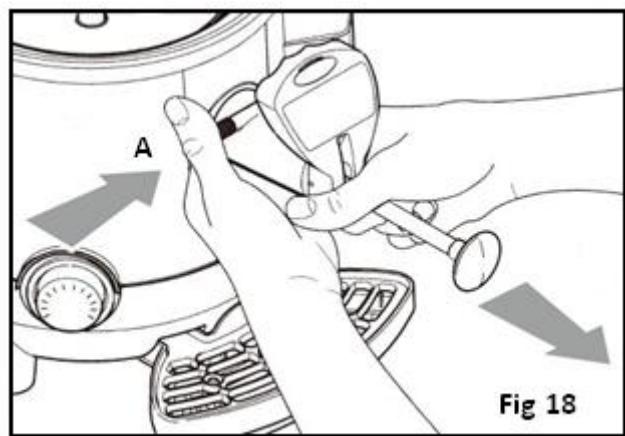
**Fig 18****De waterpan reinigen**
