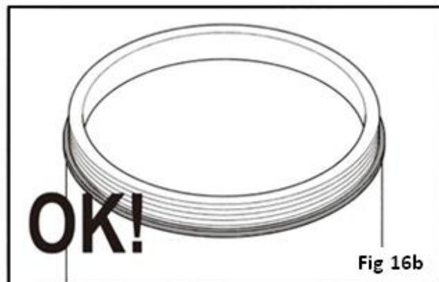
Humidifiez le joint d'étanchéité avec de l'eau, et remettez le bol en place.
